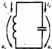
Рис. О.14. Схема замещения LC-контура
