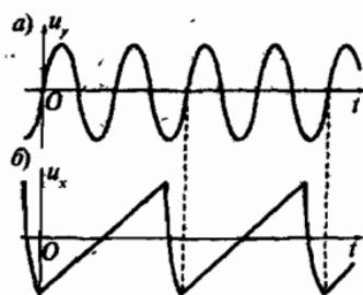
Рис. О.10. Синхронная работа генератора развертки с изучаемым сигналом: изучаемый сигнал (а); синхронное с ним напряжение генератора развертки (б)
