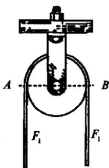
Рис. Б.6. Схема устройства простого блока
