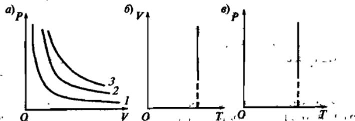
Рис. И.3. Графическое представление изотермического процесса в газах на  $P-V$  (a),  $V-T$  (б) и  $P-T$  (в) диаграммах
