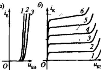
Рис. Б.4. Семейства входных (а) и выходных (б) характеристик транзистора
