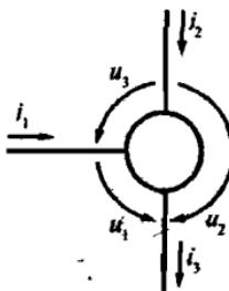
Рис. Т.5. Схематическое обозначение трехполюсника с направлениями отсчета напряжений и токов
