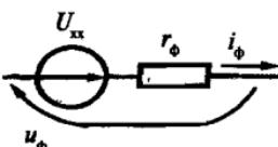
Рис. П.12. Линейная схема замещения фотоэлемента
