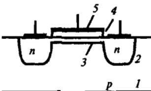
Рис. У.1 Схематическое изображение унипольного транзистора в разрезе
