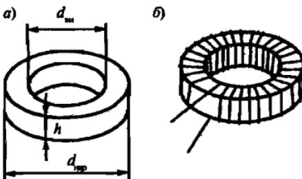
Рис. Г.2. Кольцевой сердечник из ферромагнитного материала (а); он же с обмоткой (б)
