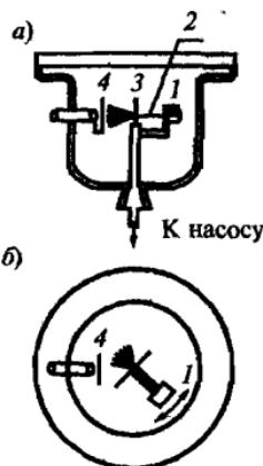
Рис. О.2. Схема установки в опытах Э.Резерфорда по исследованию рассеяния  $\alpha$ -частиц: вид сбоку (а) и вид сверху (б)
