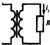
Рис. В.3. Трансформатор, нагруженный резистором
