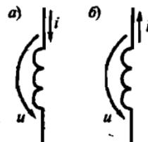
Рис. И.6. Условное графическое обозначение индуктивной катушки и направлений отсчета напряжения и силы тока: согласного (а) и встречного (б)
