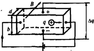
Рис. Э.5. Схема установки для наблюдения эффекта Холла в плоской пластине исследуемого вещества
