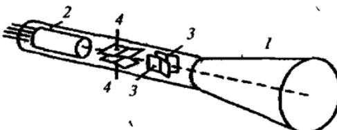
Рис. О.5. Электронно-лучевая трубка
