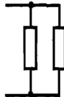
Рис. П.1. Параллельное соединение двухполюсников
