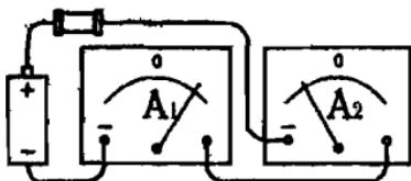
Рис. П.23. Два способа включения амперметра
