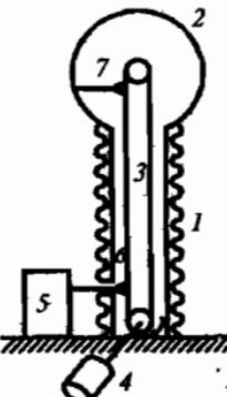
Рис. Г.1. Схематическое изображение генератора Ван-дер-Граафа в разрезе
