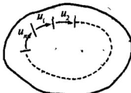
Рис. 3.6. К формулировке второго закона Кирхгофа
