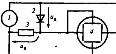
Рис. О.12. Предельно упрощенная блок-схема установки для получения на экране осциллографа вольт-амперной характеристики диода
