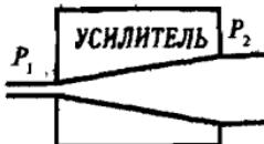
Рис. У.7. Ошибочное представление принципа действия усилителя
