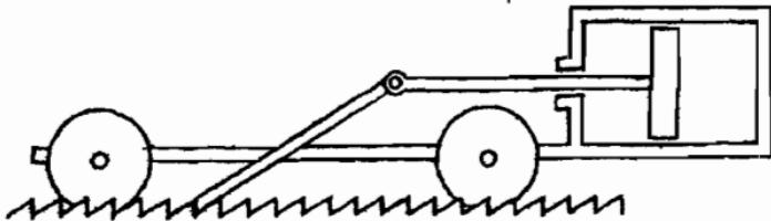
Рис. С.1. Кинематическая схема “ногатого” паровоза
