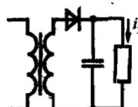
Рис. В.5. Однополупериодный выпрямитель с конденсаторным фильтром
