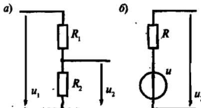
Рис. Д.5. Схема делителя напряжения
