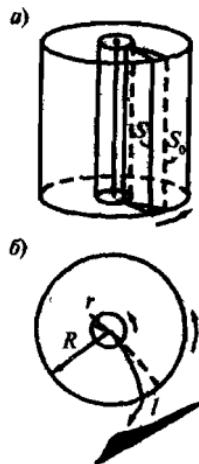
Рис. О.4. Схема установки в опытах О.Штерна по определению скорости молекул серебра: вид сбоку (а) и вид сверху (б)
