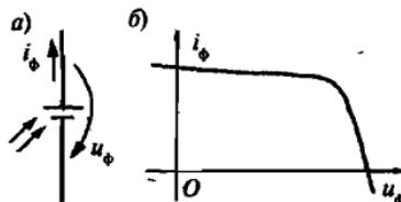
Рис. С.3. Условное графическое обозначение фотоэлемента (а) и его вольт-амперная характеристика (б)
