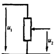
Рис. П.18. Потенциометрическое включение резистора переменного сопротивления
