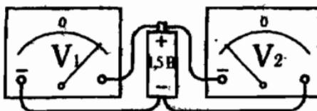
Рис. П.22. Два способа включения вольтметра
