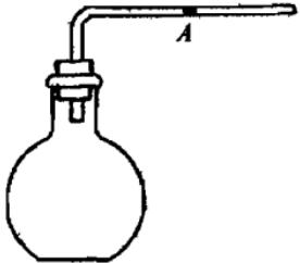
Рис. И.2. Простейшее устройство для наблюдения изобарического расширения и сжатия газов
