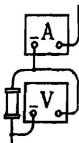
Рис. П.24. Согласное включение вольтметра и амперметра
