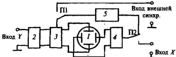
Рис. О.11. Упрощенная блок-схема осциллографа
