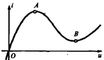
Рис. Д.12. Вольт-амперная характеристика туннельного диода
