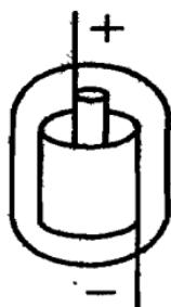
Рис. И.10. Схематическое изображение ядерного источника питания
