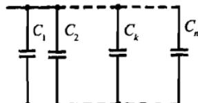
Рис. П.3. Параллельное соединение n конденсаторов
