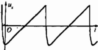
Рис. О.8. Пилообразное напряжение генератора развертки
