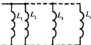
Рис. П.2. Параллельное соединение n индуктивных катушек
