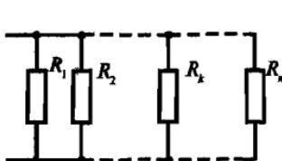
Рис. П.4. Параллельное соединение *n* резисторов
