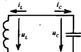
Рис. Р.7. Схема  $LC$ -контура с указанием направлений отсчета токов и напряжений
