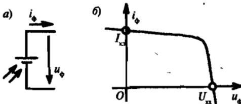
Рис. 3.1. Условное графическое обозначение солнечного фотозлемента (а) и его вольтамперная характеристика (б)
