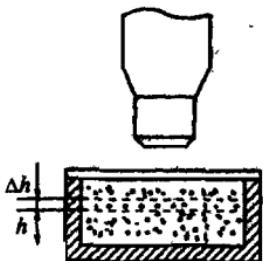
Рис. О.1. Схема установки в опытах Ж.Перрена по определению числа Авогадро
