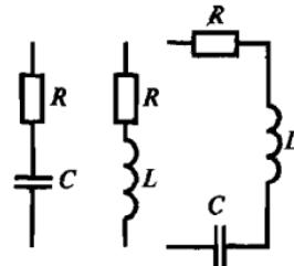
Рис. Р.5. Ветви из разнородных элементов, соединенных последовательно
