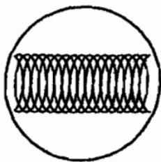
Рис. О.9. Изображение на экране осциллографа при отсутствии синхронизации
