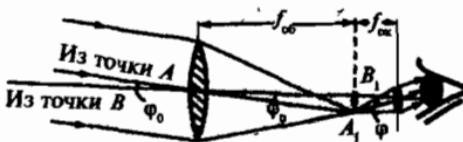
Рис. 3.8. Оптическая схема трубы Кеплера
